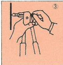
3) 取付完了。工具上部のマンドレル・ノズ3を左ネジ方向に回せば、工具はナットサートからはづれます。
