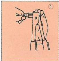
1) ハンド・ツールの柄を全開に広げた状態で工具先端ノーズにナットサートをねじ込み、下穴に挿入。
